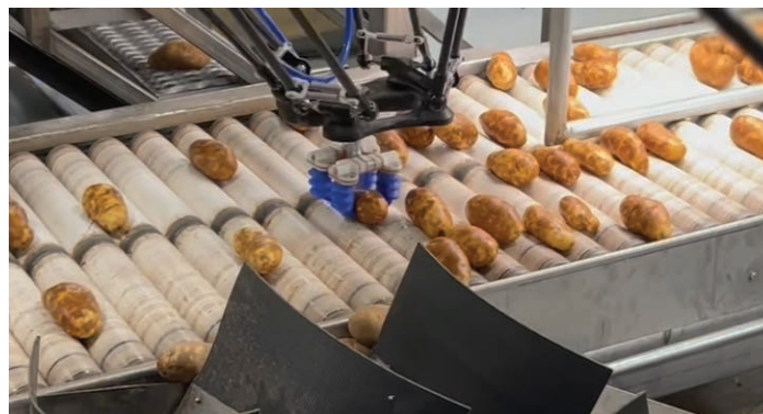
Sortowanie i kontrola wizyjna ziemniaków
